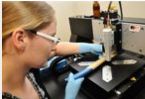
Biochemikerin Anja Bräutigam legt ein Tat-Beil unter das Scann-Gerät, das den Stiel mit einem weißen Lichtpunkt abtastet.
